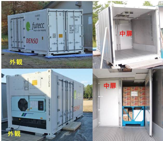
図3 多温度帯コンテナの外観および内部の様子
