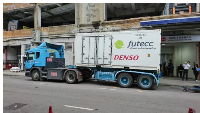
図7 農産物の混載輸送可能な多温度帯コンテナ(混載輸送コンテナ)の外観
